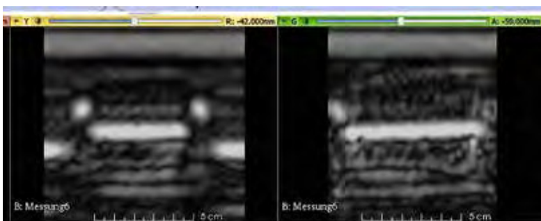
Radar-Scan eines Betontrogs
