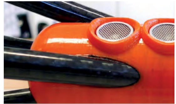
Abb. 4: Im Prototyp integrierter Messkopf zur Messung der Rohrdimension
