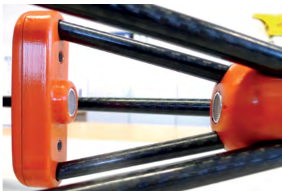
Abb. 3: Im Prototyp integrierte Sensoren zur Lufttemperatur und Luftströmungsmessung
