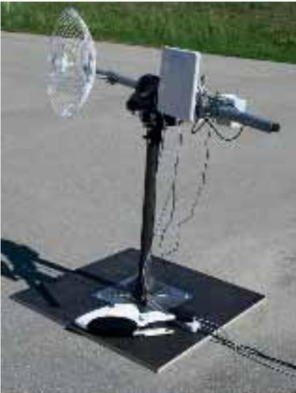
*Automatische 2-Achs-Antennennachführung mit einer 5,8-GHz-Patchantenne und einer 2,4-GHz-Parabolantenne*
