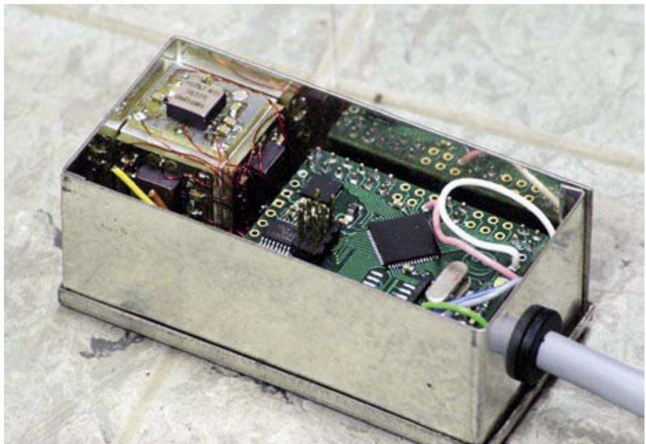
Blick in das geöffnete Kurs-Lagereferenzsystem. Auf dem würfelförmigen Block sitzen drei MEMS-Kreisel und -Beschleunigungsmesser mit Elektronik. Der Rechner, der die Sensordaten in Lagewinkel umrechnet, ist auf der Elektronikkarte zu sehen.
